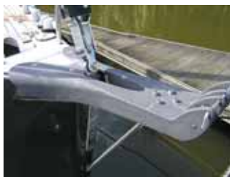
Der etwas martialisch wirkende Vorbau ist Anschlagpunkt für den Gennaker und trägt zwei Rollen für die Kette.
