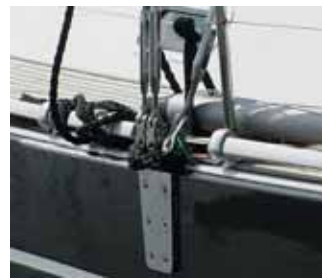
Die Rüsteisen sind außen auf die Bordwand montiert. Ein wenig grob, aber durchaus Vertrauens erweckend.
