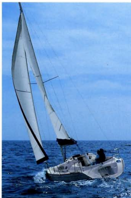
Feeling 32: scharfer Vorsteven und breites Heck garantieren hohe Geschwindigkeiten
