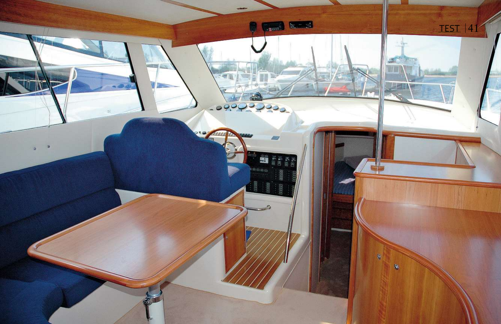
Das mit akkurat eingepassten Kirschholzmöbeln eingerichtete, 1,96 m hohe Ruderhaus bietet reichlich Bewegungsfreiheit
