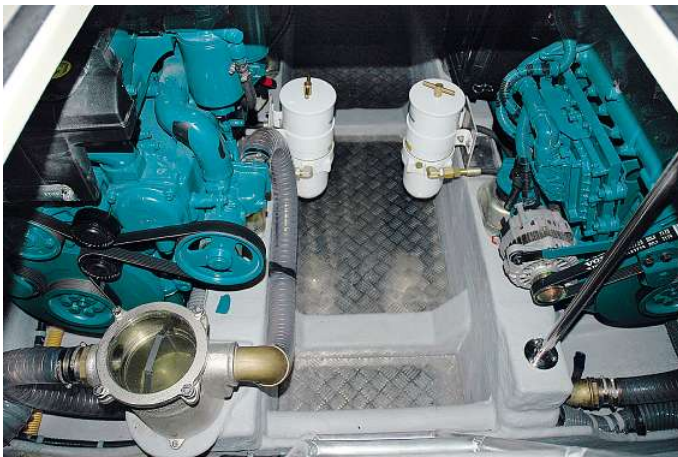
Volvo-Power im Doppelpack: Die D6-370-Diesels leisten 544 kW
