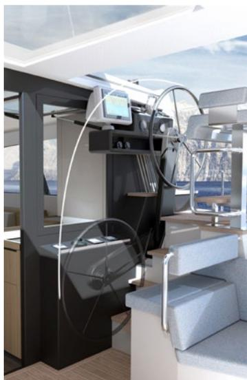
Le poste de barre extérieur de l'Explocat 52 est équipé d'un système de barre à roue pendulaire. Ce dispositif permet de barrer soit en position basse à l'abri du cockpit, soit en hauteur pour les manœuvres et la navigation par beau temps.
